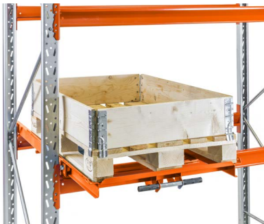
Uttrekkseth - for ergonomisk riktig plukking fra pall. Montering på bærene. Maks. belastning 700 kg.
