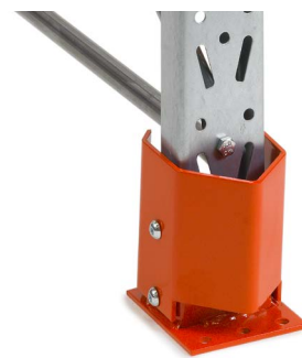
Stolpeforsterkning 90 - brukes sammen med Stosfotplate. Beskytter stolpens nedre del uten å stjele plass i reolen. H : 150 mm.
