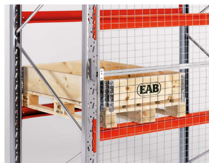
Rassikring - kraftig nettingramme monteres på reolens bakside og hindrer at gods faller ned fra paller.
