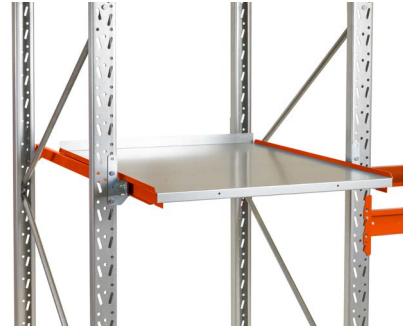
Uttrekkshylle - for lagring av mindre kolli uten pall. Bredde 950 mm Maks. belastning 300 kg.
