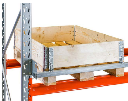
Pallstopp horisontal - monteres i bakkant og hindrer at pallen skyves for langt inn i reolen.
