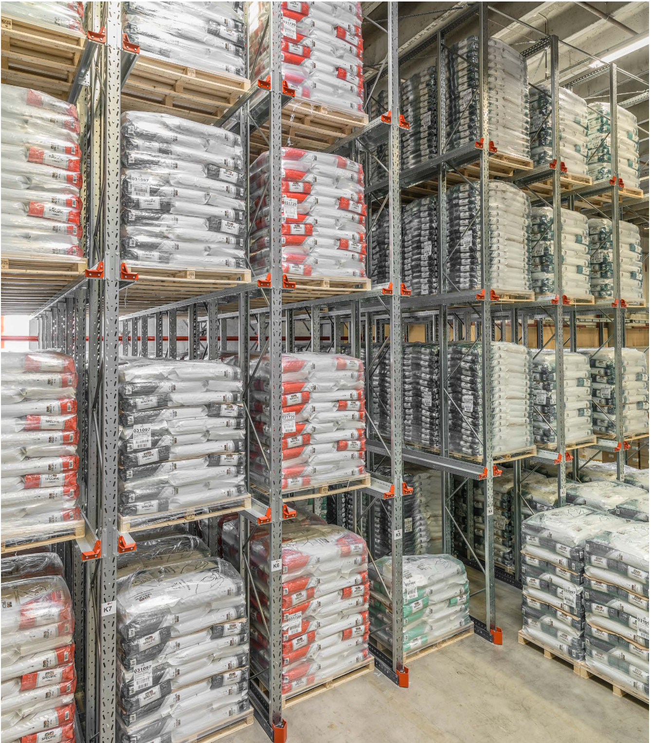
Gjennomføringsbeskyttelse hindrer at pallen skyves for langt inn
