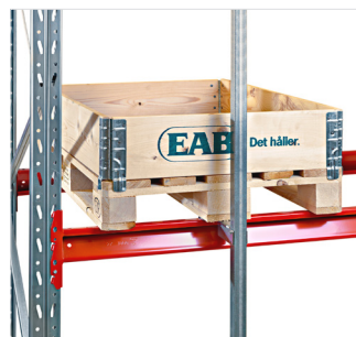
Vertikale pallestoppere – monteres i bakkant av stigen for å hindre at paller skyves for langt inn.
